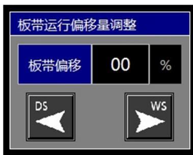
偏移是指在板带的对中或纠偏过程中，对板带基准的微调。它允许的调节范围为-30%~30%。相对于板带的实际距离，依据传感器的种类和安装规范会有较大差异。偏移调节采用“步进”方式，即每点一下，偏移量变化一个步距。默认的步距是1%。
