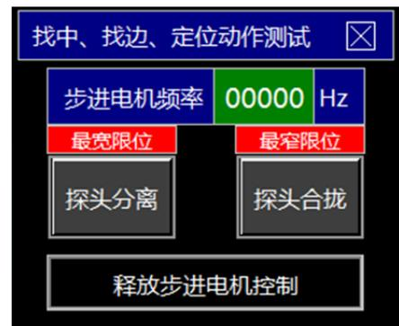
在步进电机行走缓慢时，可以降低“步进电机频率”试试。如果降低后情况好转，大部分的原因是丝杆的原因造成的。或者配合过紧，或者生锈严重，或者润滑不够等，请根据检查的实际原因排除解决。
